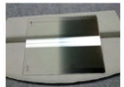
B社製 ハーフND ミラーのように反射が強い。
