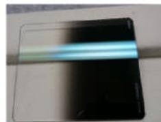
Cokin NUANCES GND 反射が抑えられていて、反射の色味も揃っている。(グリーン系の色味で統一)
